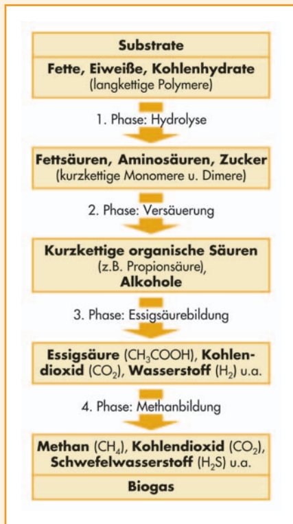
Abb. 2: Vereinfachte Darstellung des Abbaus organischer Substanz bei der Biogasgewinnung
